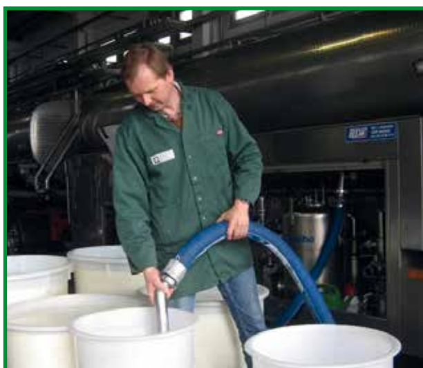
Abb. 4.1.1. Überprüfung von Probenahmeanlagen nach DIN 11868-1
