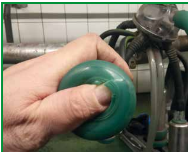
Abb. 4.2.3.: Stark verschlissener Zitzengummi
